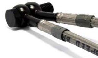
Bremsleitung mit Doppelhohlschraube brake line with double banjo bolt
