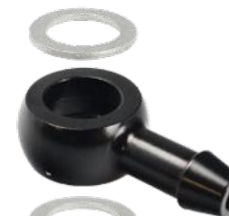
Zufuhrstück Ringanschluss mit Nippel feeding piece ring connection with nipple 90° ø 8.0 & Hohlschraube banjo bolt M10x1.00, Länge / length 19
